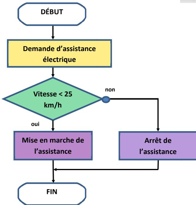
Figure 3 : algorithme traitant la demande d'assistance électrique.
