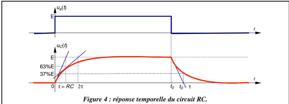
Figure 4 : réponse temporelle du circuit  $RC$ .
