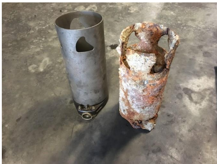
La chemise louvoyante, caractéristique des moteurs Bristol Hercules qui équipaient les Halifax. (Photo : Olivier Brichet)
