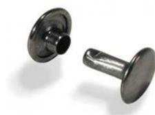
Le rivet se compose d'une pièce mâle et une pièce femelle que l'on va venir emboîter ensemble à l'aide d'une pince à rivet ou d'un petit marteau.
