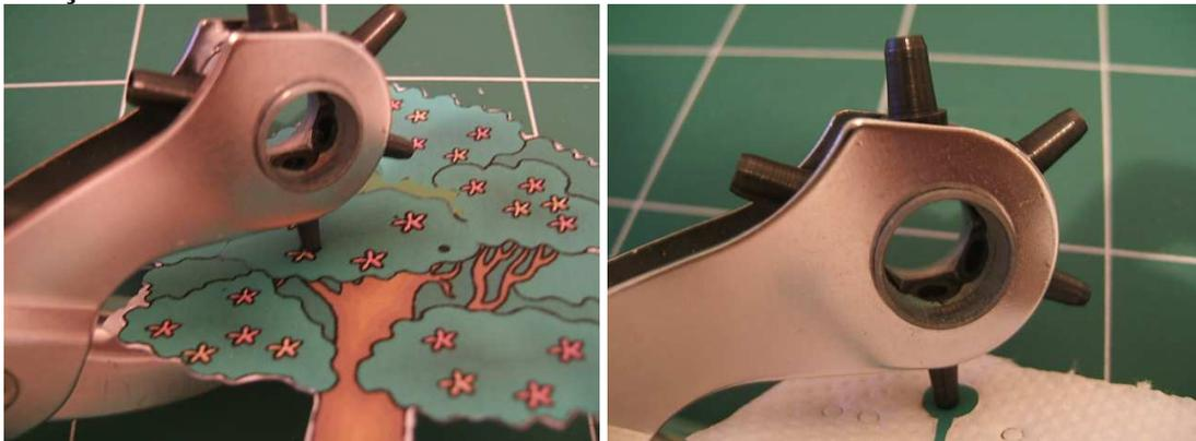
Percer avec le plus petit diamètre les trous marqués d'un rond noir sur les différentes couches du modèle.
